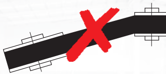
Horizontale Winkelabweichung der Achsen Horizontal angle deviation of the shafts
